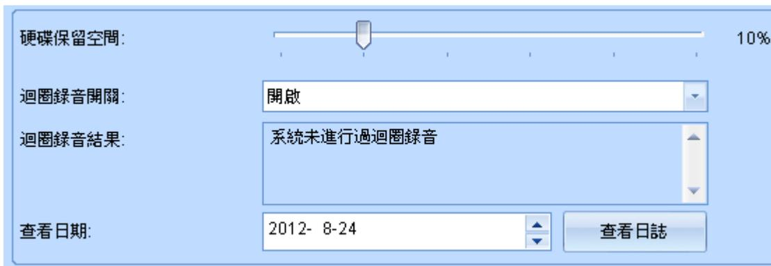
顯示當前硬碟的容量資訊,剩餘空間,以及系統運行了總時長,根據當前的使用情況,計算硬碟大致還可以使用的时间,該時間不一定準確,因為是根據到目前為止已經使用的空間平均值來計算,實際使用日期跟使用環境有關係
